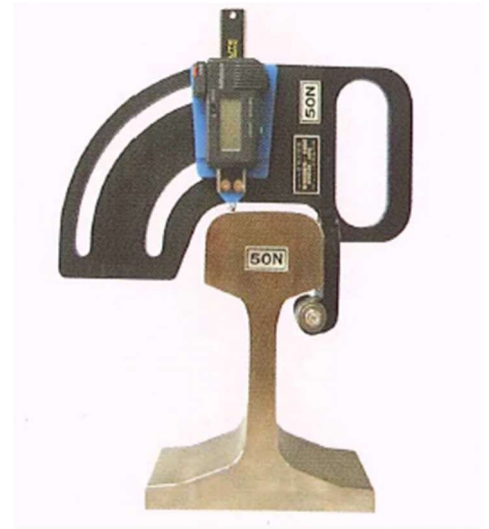
【レールの測定器具（頭面と側面）】
