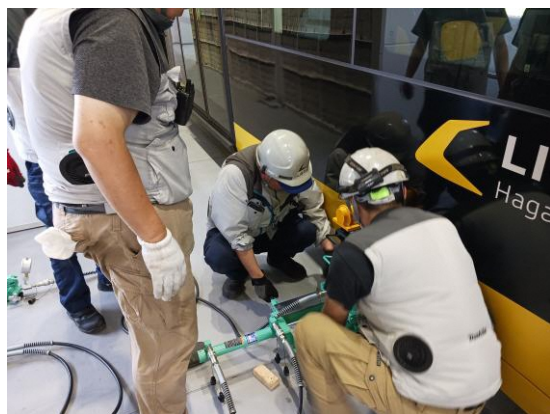
【装置を車両床下に取りつけ】
