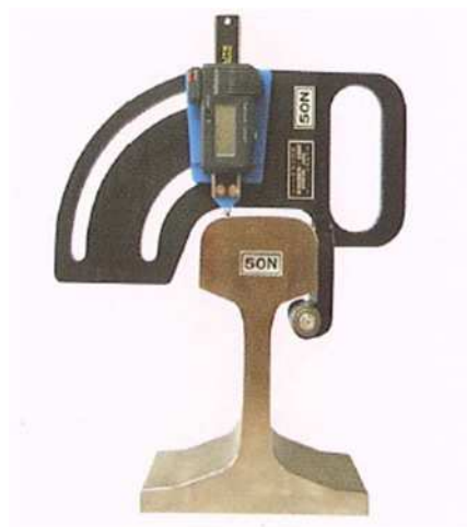
▲ レールの測定器具 (頭面と側面)
