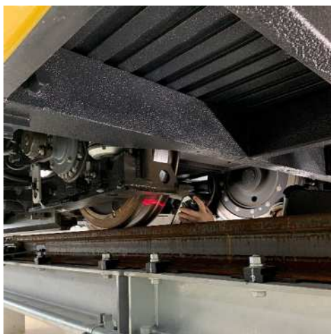
▲ 車輪フランジの測定器具 (厚さと高さ)
